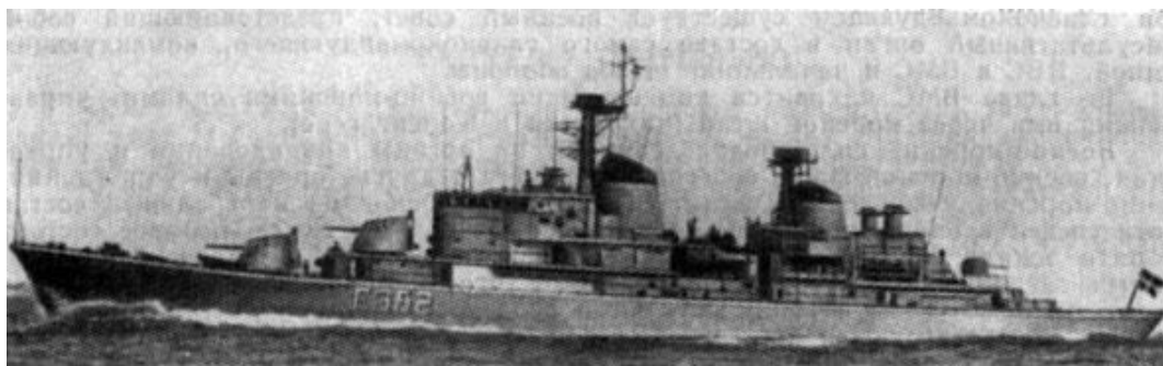
Фото 13. СКР ВМФ Дании 2 ед. «Педер Скрам» и «Херлуф Тролл» (67-68 гг). 2200 т, 28 уз. Дизель 4800 л.с. Газ. Турб. 37 000 л.с. 2 винта. Размеры: 110,9×11,0×4,3 м, 2×2-127-мм универс. орудия. 4-40-мм авт. 1×3-533-мм ТА ПЛЮ. Бомбомет. Экипаж 200 чел.
