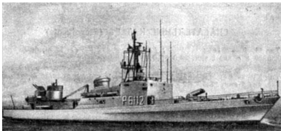
Фото 11. Противолодочные корабли ВМС ФРГ. Тип Тетис – построено 5 ед. (61-63 гг). Тетис, Гермес, Няде, Тритон, Тезеус. 564/680 т, 24 уз, 6000 л.с. дизель, 2 винта. Размеры: 70,0×8,2×2,3 м, 1×2-40-мм авт, 2 реакт. бомбомета "Бофорс", экипаж 48 чел. Используются в
